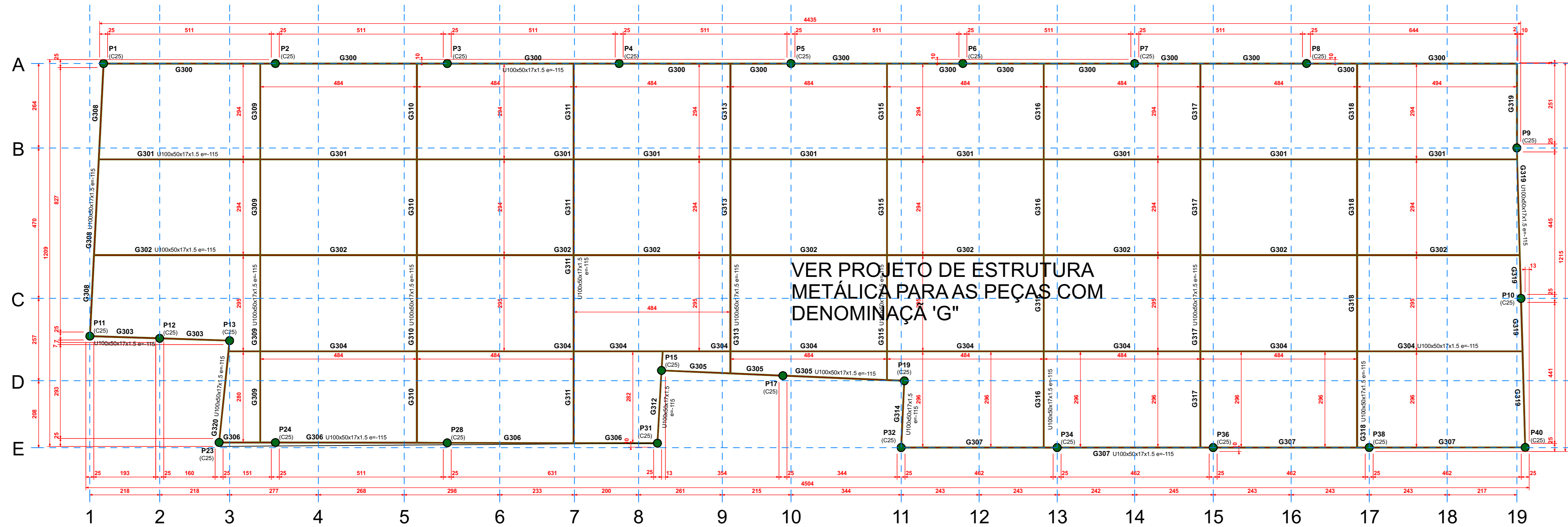
FORMA DO PAVIMENTO ENTRADA CAMARA (NÍVEL 53800) ESC.: 1:75
